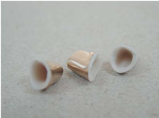
Abb. 15: Präzise und leicht: Die gegossenen Sekundärteile sind gleichmäßig dünn und wiegen zusammen nur 1,3 Gramm.
