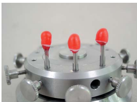
Abb. 11: Mit Pattern Resin werden die Sekundärteile modelliert.
