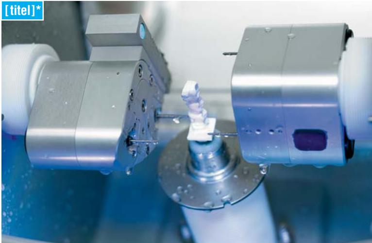
*\*In der neuen Schleifeinheit inLab MC XL von Sirona wurde das zeitsparende Zwillings-Schleifkonzept weiterentwickelt: es übertrifft die Schleifgeschwindigkeit der bewährten inLab-Schleifmaschine um bis zu 60 Prozent.*
