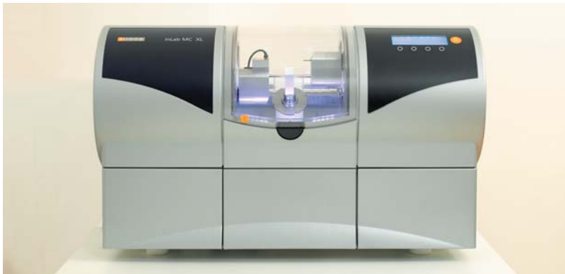
Abb. 1: Die Schleifeinheit inLab MCXL ist auf dauerhaft hohe Belastungen und lange Standzeiten ausgelegt, wie sie in großen Dentallabors zu bewältigen sind.
