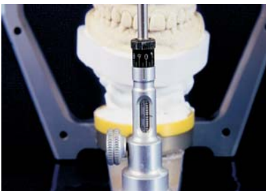
Abb. 6: Die Messung der Registratstärke am Stützstift zeigt 0,85 mm an. D.h. effektiv 0,15 mm, dies entspricht einer Dicke im Molarenbereich von etwa 1/10 mm.
