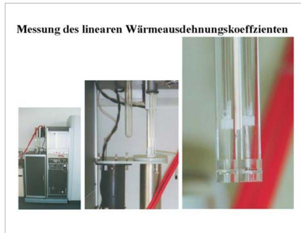
Abb. 4: Ansichten eines Dilatometers.
