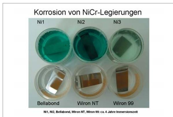
Abb. 3: Verfärbte Korrosionslösungen von Nickel-Chrom-Legierungen mit unterschiedlichen Chromgehalten: Je dunkler die Lösung ist, desto höher die Konzentration an in Lösung gegangener Ionen.
