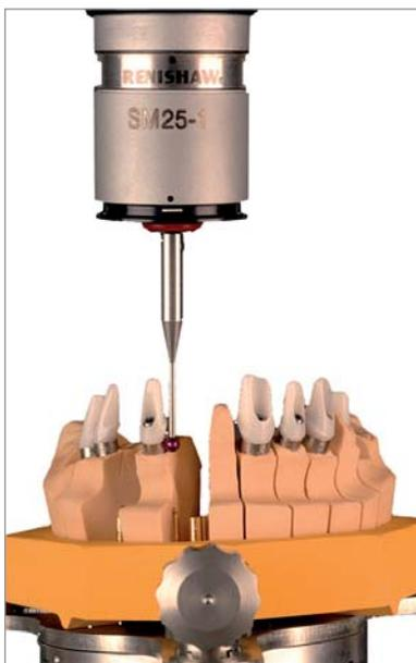
Abb. 5: Um die Abutments auch einzeln einschnitten zu können, werden sie auf ein Sägemodell umgesetzt. Die Anschaffung eines solchen Scanners ist zwar nicht gerade günstig, Prozess- wie Ergebnisqualität stabilisieren die Kundenbindungen jedoch spürbar, macht diese Technik viele Versorgungsformen, die zunehmend von den Patienten gewünscht werden, erst möglich.
