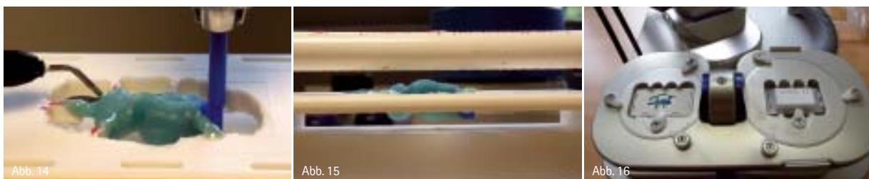
Abb. 14: Die Arbeit wird in den Fräsrahmen einpolymerisiert. – Abb. 15: Sitzt und hat Luft: Wenn die Modellation nirgendwo anstößt, können wir die Restauration ins Fräsgerät einspannen. – Abb. 16: Die Arbeit im Fräsgerät. Rechts ist der Zirkon-Rohling eingespannt.
