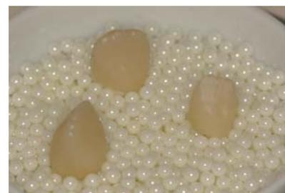
Abb. 6: Kontrolle der gefrästen Kronen auf dem Meistermodell (im vorkristallinen Stadium). – Abb. 7 und 8: IPS e.max CAD-Dentinkerne auf dem Sinterträger vor und nach dem Kristallisationsbrand. Diese wurden aus IPS e.max CAD LT-Rohlingen gefertigt (LT = low translucency).
