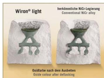
Eine helle Oxidfarbe, eine besonders glatte Oberfläche und leichtes Ausarbeiten sind die wichtigsten Vorteile der neuen EMF-Legierung Wiron® light von BEGO. Die abgesenkte Gießtemperatur von nur 1.350 °C und eine Vorwärmtemperatur von 800 °C reduzieren die Reaktion der Legierung mit der Einbettmasse. Herausragende Festigkeitswerte lassen graziles Arbeiten und große Spannweiten zu, und eine Vielzahl marktgängiger
