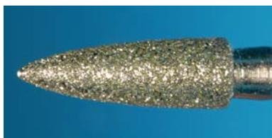
Abb. 5: Konvexe Schleifkörpergeometrien bieten mehr Freiheitsgrade bei der Gestaltung der Kronenform.
