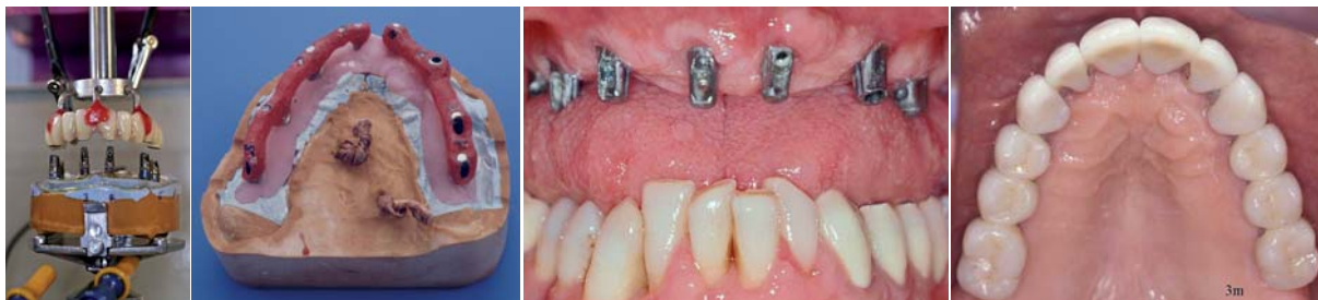
Abb. 19: Durch die keramische Verblendung kommt es durch den thermischen Prozess erneut zu Fehlpassungen und Spannungen in der Brückenstruktur. Diese Fehlpassungen werden beim anschließenden Nacherodieren völlig beseitigt. Um Schäden an der Keramik zu verhindern, muss die Struktur zur Kühlung in der Funkenerosionsmaschine mit Dielektrikum umspült werden. – Abb. 20: Um dem Zahnarzt das Einsetzen der Implantataufbauten zu erleichtern, werden über die individualisierten Ästhetikpfosten zwei Positionsschlüssel aus Modellierkunststoff angefertigt. – Abb. 21: Die individualisierten Ästhetikpfosten konnten somit modellbezogen eingesetzt und auf den inserierten Implantaten festgeschraubt werden. – Abb. 22: Die definitiv befestigte Brückenstruktur in situ.
