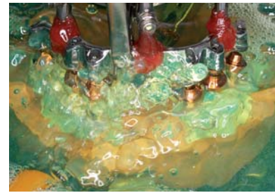
Abb. 26: Der Funkenerosionsprozess auf Kupferelektroden im Dielektrikum.
