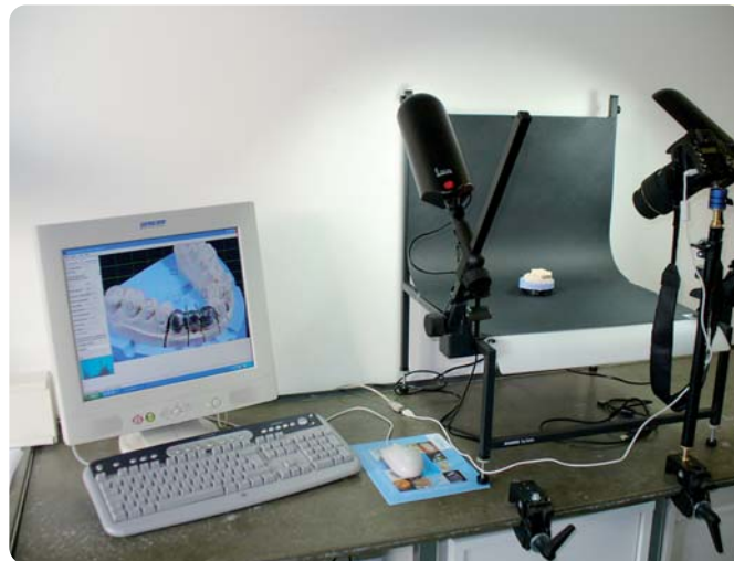
Abb. 2: Fototisch mit Beleuchtungssystem.
