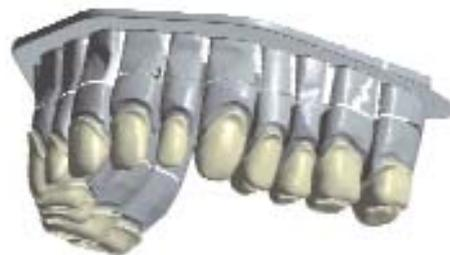
Abb. 6: 14 Einzelzahnkronenkappen als CAD-Datensatz.
