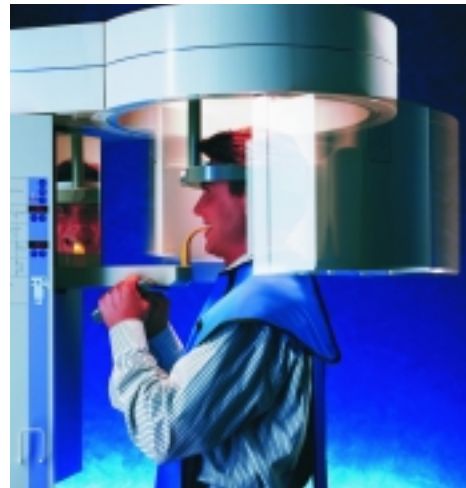
Das digitale Panoramaröntgengerät ORTHOPHOS Plus DS von Sirona ist auch mit TSA-Option erhältlich: Die Transversalen Schichten ermöglichen zusätzlich zur Panoramaaufnahme die Darstellung in einer zweiten Ebene.
