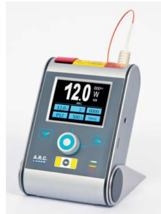
Abb. 9: Der im vorgestellten Fall verwendete Diodenlaser: FOX (Fa. A.R.C. Laser).
