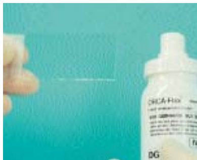
Abb. 8: Die Ausstriche sofort (innerhalb von 5-10 Sekunden) aus etwa 25 cm Entfernung 3-5x mit dem ORCA-Fixx-Spray satt einsprühen, bis ein durchgehender Flüssigkeitsfilm entstanden ist. Objektträger dabei waagrecht halten. Nachdem die Proben getrocknet sind (10-20 Minuten), können diese an den Pathologen verschickt werden.
