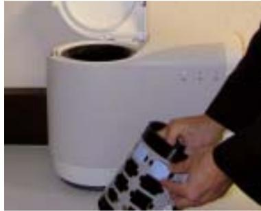
Abb. 8: Dagegen ist bei den DenOptics-Speicherfolienscannern (Gendex) ein deutlich höherer Zeitaufwand einzukalkulieren, weil die Speicherfolie von Hand in einem abgedunkelten Zimmer auf eine Trommel gespannt und mit dieser in das Gerät eingesetzt werden.
