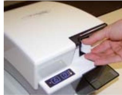
Abb. 9: Auch bei den Optime-Geräten (Digora) erfolgt die Überführung der Speicherfolie aus ihrer Hygienehülle in den Scanner in Sekunden.
