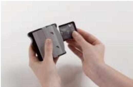
Abb. 3: Mit einem Handgriff wandert die Speicherfolie aus der Schutzhülle in die Kassette, die zwei Folien aufnehmen kann.
