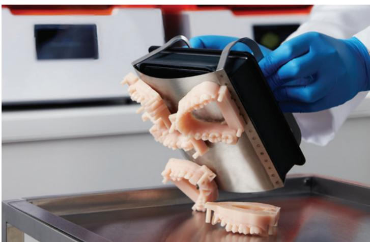
Dank der patentierten Schnellablöse-Technologie der Build Platform 2 von Formlabs können die Druckteile in Sekundenschnelle und ohne Zuhilfenahme von Werkzeugen von der Konstruktionsplattform entfernt werden. (Fotos: © Formlabs)
