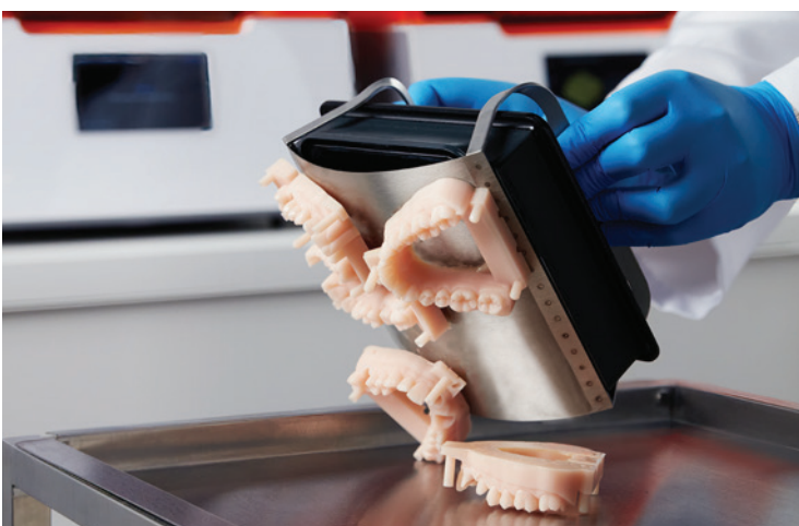
Dank der patentierten Schnellablöse-Technologie der Build Platform 2 von Formlabs können die Druckteile in Sekundenschnelle und ohne Zuhilfenahme von Werkzeugen von der Konstruktionsplattform entfernt werden. (Fotos: © Formlabs)
