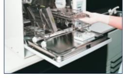
Kassettenautoklav. Beispiel eines S-Prozesses, geeignet für die Sterilisation von metallene Hohlkörper.
