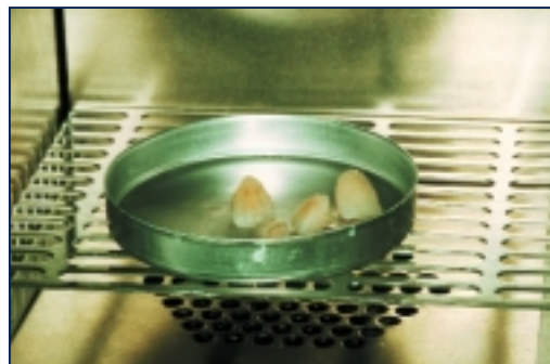
(Abb. 13) ▶ Auf Grund der thermischen Vergütung werden die optimalen Materialeigenschaften von Estenia erreicht.
