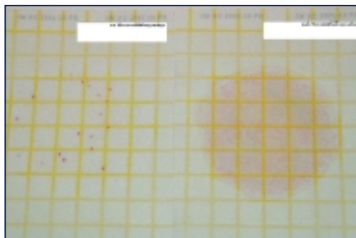
Keimtest vor und nach der Wasserenthärtung.
