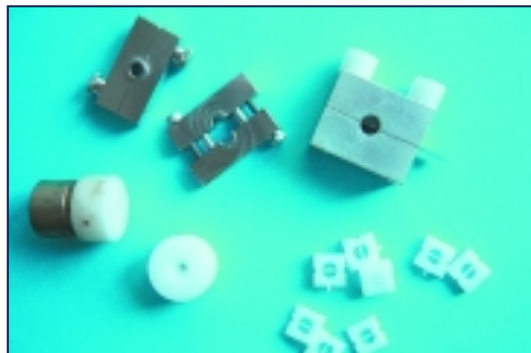
Passives Kühlsystem der LED.
