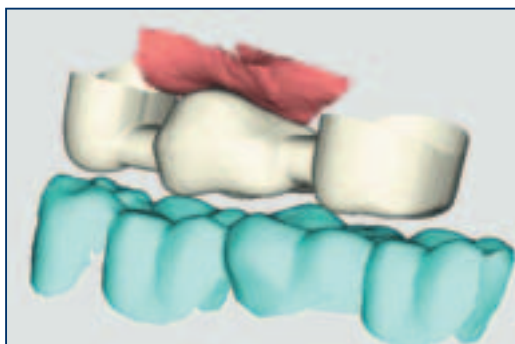
▶ CAD-Modell unter Berücksichtigung der Antagonistischen Bezahnung. Quelle: ce.novation, inocermic, Hermsdorf, D
