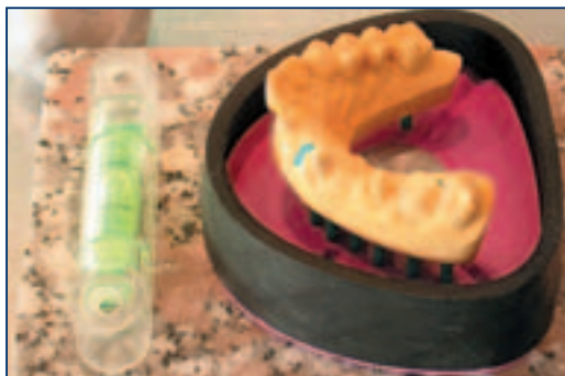
(Abb. 7) ▶ Um ein sauberes Anlaufen des Sockelgipses zu erreichen, muss eine horizontale Ebene mit Knete und Wasserwaage ausgerichtet werden.
