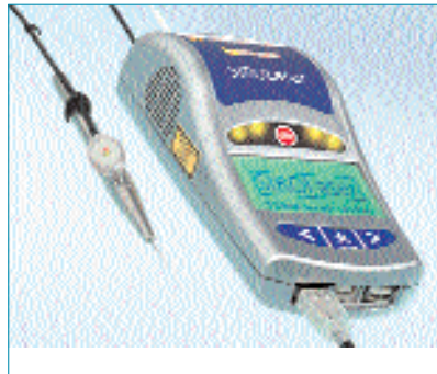
Der neue Diodenlaser SIROLaser ist für den Einsatz in Endodontie, Parodontologie und dentaler Chirurgie konzipiert.
