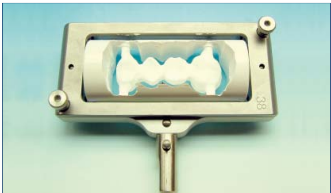
(Abb. 1) ▸ Vorgesintertes Zirkoniumdioxidgerüst einer viergliedrigen Brücke nach dem Fräsprozess.
