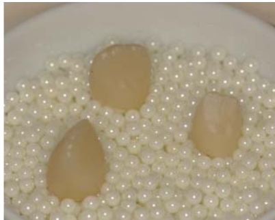
▲ Abb. 7 und 8: IPS e.max CAD-Dentinkerne auf dem Sinterträger vor und nach dem Kristallisationsbrand. Diese wurden aus IPS e.max CAD LT-Rohlingen gefertigt (LT = low translucency). ▲ Abb. 9: Nach dem Kristallisationsvorgang erhalten die Dentinkerne ihr endgültiges, zahnfarbenes Aussehen.
