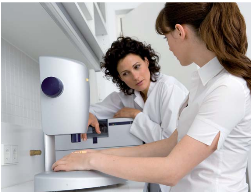
▲ Abb. 4: Der inEos-Scanner von Sirona ergänzt das in Lab-System für Zahntechniker. In Sekundenschnelle erfasst er Einzelstümpfe, Brückensituationen und Ganzkiefermodelle. Dadurch steigt die Effizienz der Dentallabore.
