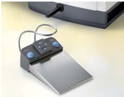
▲ Abb. 3: Die Option, TENE0 komplett über den Funkfußschalter zu steuern, ermöglicht längere Behandlungsabläufe ohne Unterbrechung der Hygienekette.
