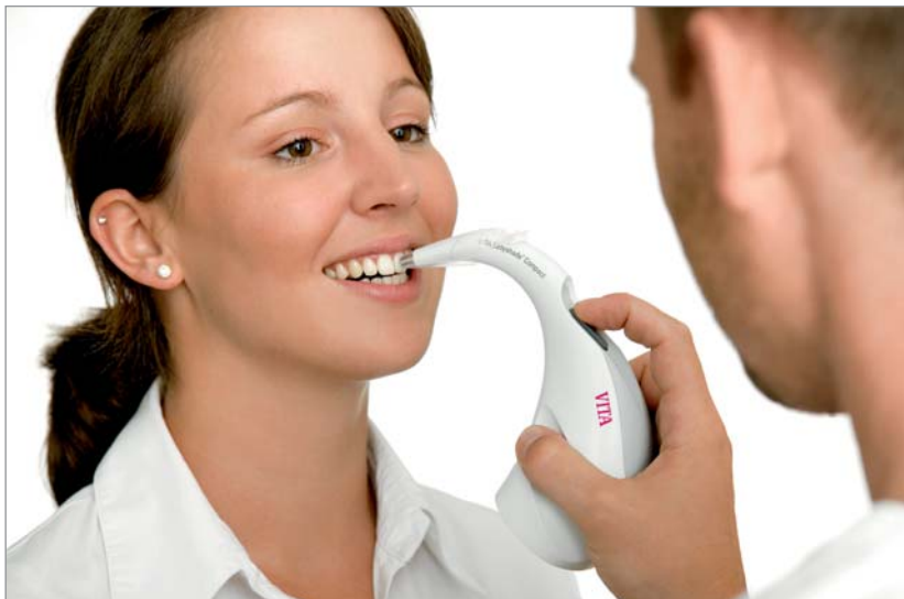
▲ Abb. 2: Für die Messung wird die Sonde senkrecht und bündig an die Zahnoberfläche gehalten.
