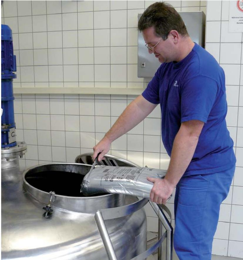
▲ Produziert werden die Desinfektions- und Reinigungsmittel in 5.000 Liter fassenden Kesseln.
