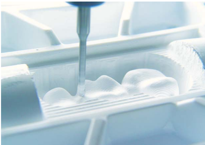
▲ Abb. 1: Großdimensionierte Fräsaufmaschinen liefern eine hohe Passgenauigkeit der Gerüste. (Foto 3M ESPE)
