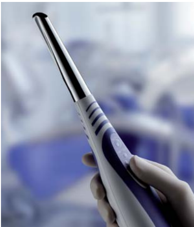
▲ Abb. 2: Handstück: Das Handstück des Lava Chairside Oral Scanner C.O.S. vereint 22 Linsen und 192 LEDs mit einer hochkomplexen Videokamera. Es wird einfach über die Zahnreihen geführt und rechnet zeitgleich die Scan-Daten in ein 3-D-Modell um. Das Weichgewebe wird bei einer Abformung nicht komprimiert, sodass das Ergebnis die unverfälschte Basis für präzisen Zahnersatz darstellt.
