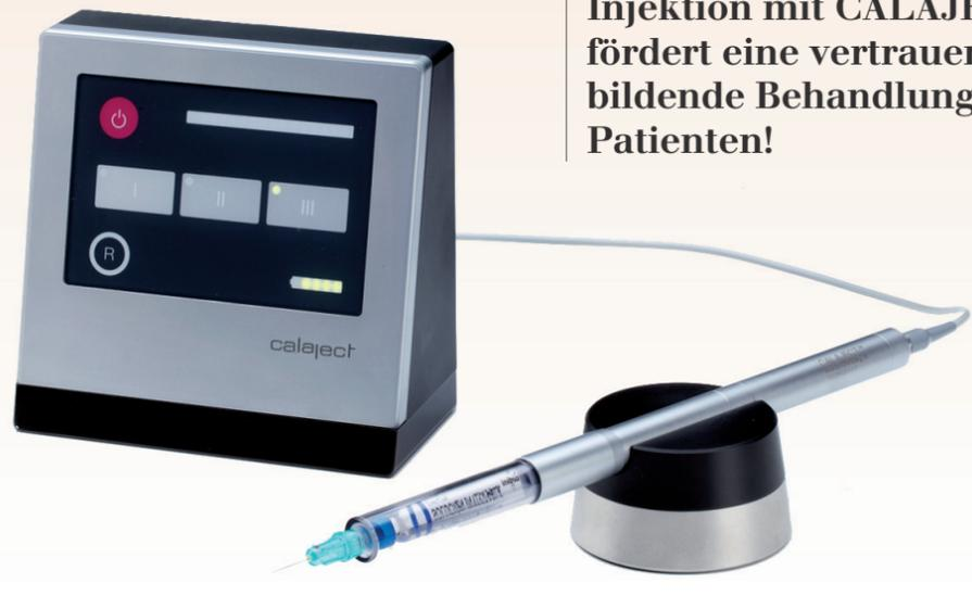
Absolut geräuschloser und vibrationsfreier Betrieb sind durch das Handstück bei allen Einstellungen mit Sichtbarkeit der Zylinderampulle während der gesamten Injektion gegeben. Alle Standard-Dentalkanülen können benutzt
