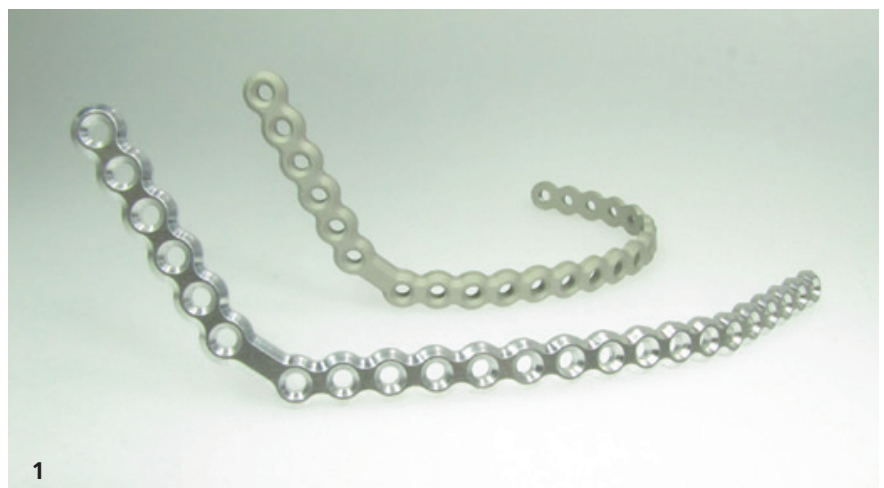
Abb. 1: Resorbierbare 3D-gedruckte patientenspezifische Osteosyntheseplatte auf Magnesiumbasis.
