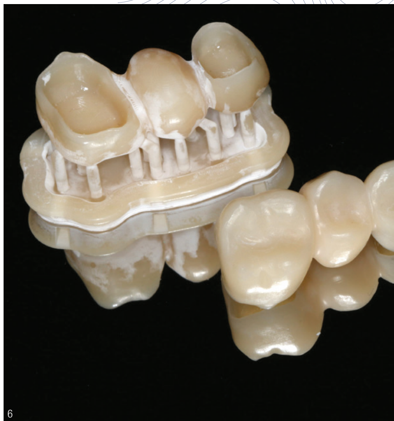
Abb. 6: 3D-gedrucktes Brückenprovisorium 14–16. Von links nach rechts sind die verschiedenen Stadien des Anfertigungsprozesses dargestellt. Links: Brücke mit Supports direkt nach dem Druckvorgang, Mittig: Brücke mit abgetrennten Supports und abgestrahlt, Rechts: fertig ausgearbeitetes Brückenprovisorium okklusal durch den Zahntechniker individualisiert, eine weitere Charakterisierung durch Bemalung ist möglich.
