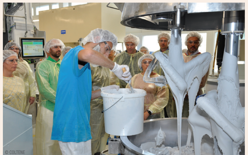
Einblicke hinter die Kulissen: Anmischung von Präzisions-silikonem.
