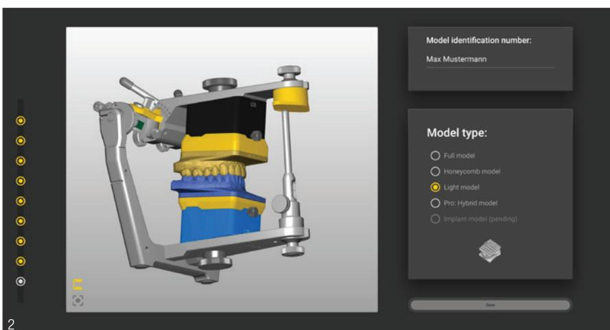
**Abb. 1:** Die anatomisch ausgerichteten Scandaten werden mithilfe des digitalisierbaren Bissgabelträgers AxioPrisa digital im Artikulator positioniert.
