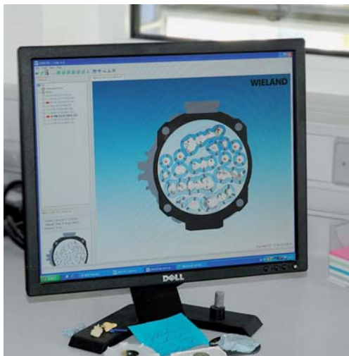
Abb. 2: Die Software erkennt, welche Stelle des Blanks für die Restauration genutzt werden kann.
