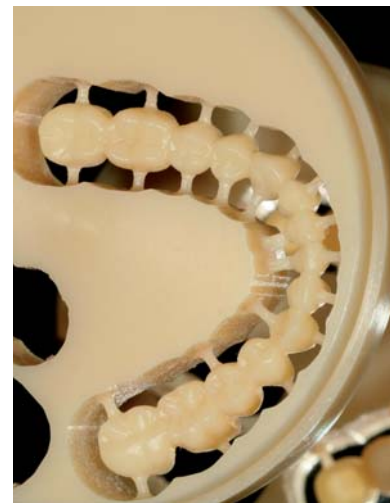
Abb. 3: Die Maschine fräst die Werkstücke aus dem Blank. Kleine Haltestifte fixieren die Restauration.
