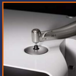
**6** Höchste Drehmomentpräzision durch das optimierte Kalibriersystem AHC: Sicherheit gegen überhöhte Drehmomente bei der Implantation.
