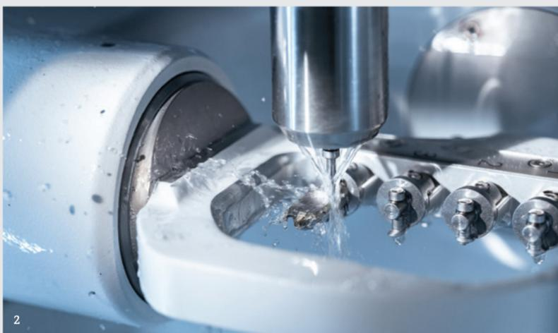
1: Ceramill Matik. 2: Die Zehn-Achs-Steuereinheit der Ceramill Matik ermöglicht maximale Indikations- und Materialvielfalt – von Zirkonoxid über Kobalt-Chrom bis zu Titan.
