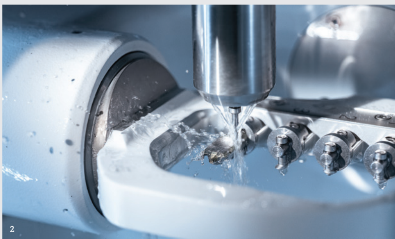
1: Ceramill Matik. 2: Die Zehn-Achs-Steuereinheit der Ceramill Matik ermöglicht maximale Indikations- und Materialvielfalt – von Zirkonoxid über Kobalt-Chrom bis zu Titan. 1: Ceramill Matik. 2: The ten-axis control unit of Ceramill Matik allows maximum indication and material diversity—from zirconia via cobalt-chromium to titanium.
