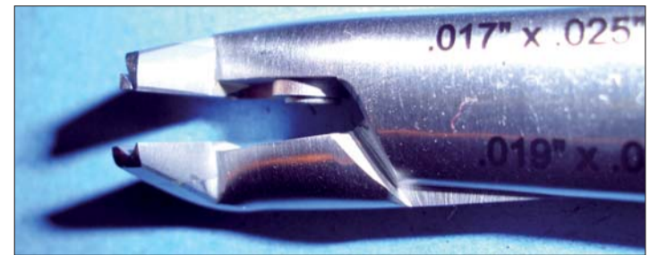
Drahtbiegezange sowie Distalendcutter (Fa. Hammacher).
