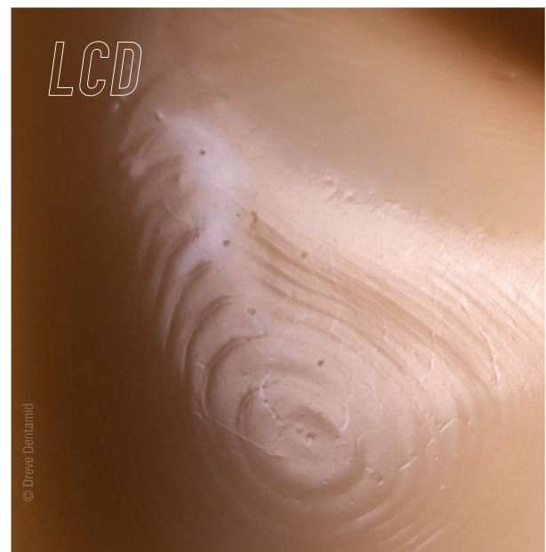
Abb. 2: Detailaufnahme der Unterseite eines hohlgelegten Dentalmodells aus FotoDent® – links: DLP, rechts: LCD.
