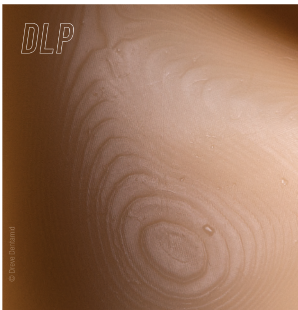
Abb. 2: Detailaufnahme der Unterseite eines hohlgelegten Dentalmodells aus FotoDent® – links: DLP, rechts: LCD.
