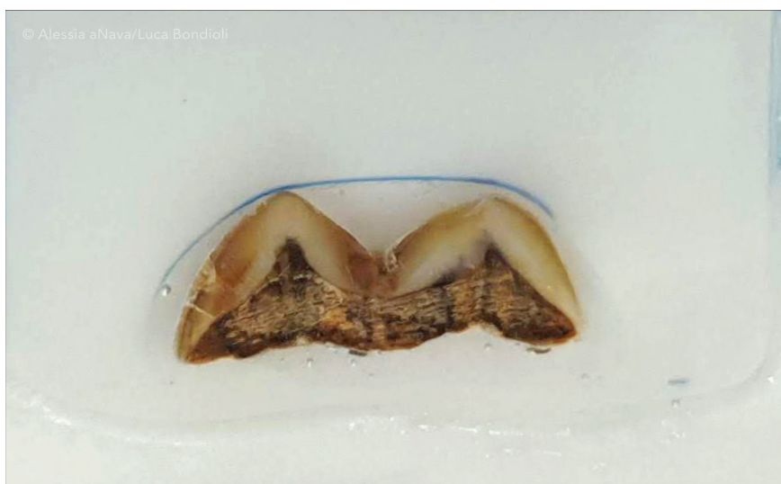
Polierter Dünnschliff eines Homo erectus-Zahnes vor der chemischen Analyse mittels Laser-Ablation-Plasma-Massenspektrometrie (LA-ICPMS).
