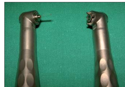
Abb. 10: Handstück R14 (links) und R02 (rechts) für den Fidelis Plus III-Laser.
