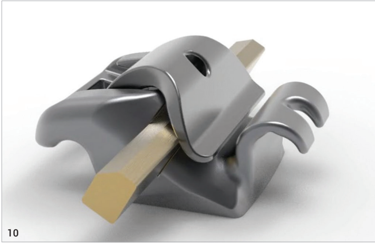
Abb. 9 und 10: Das neue WIN V-SL-Bracket mit geöffnetem superelastischem NiTi-Clip (Abb. 9) und einligiertem Fünfkant-NiTi-Bogen mit gefräster Fase, welcher durch den Snap-Lock-Mechanismus des patentierten Clips auf den Slotboden gedrückt wird (Abb. 10).
