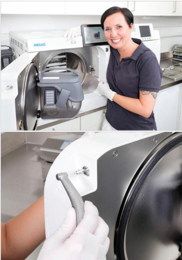
Die Carebox Blue wird auf der unreinen Seite des Aufbereiter- raums mit bis zu acht Turbinen oder Hand- und Winkelstücken bestückt und dann in Careclave eingesetzt.
