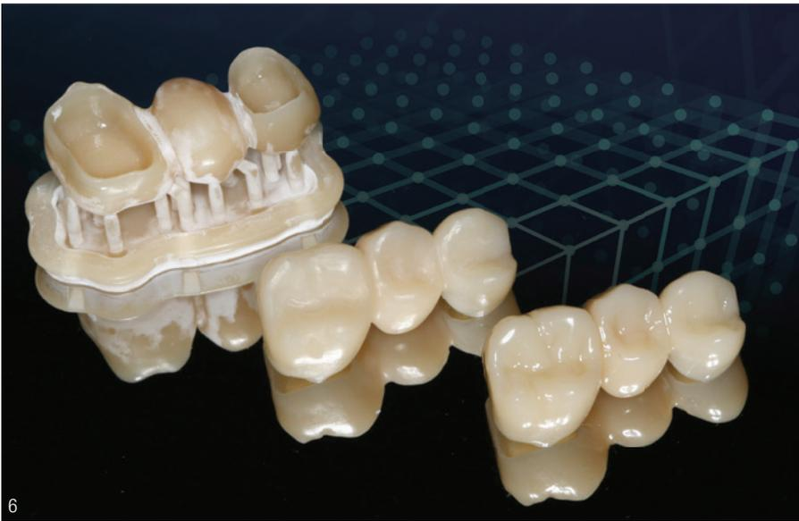
**Abb. 6:** 3D-gedrucktes Brückenprovisorium 14–16. Von links nach rechts sind die verschiedenen Stadien des Anfertigungsprozesses dargestellt. Links: Brücke mit Supports direkt nach dem Druckvorgang, mittig: Brücke mit abgetrennten Supports und abgestrahlt, rechts: fertig ausgearbeitetes Brückenprovisorium okklusal durch den Zahntechniker individualisiert, eine weitere Charakterisierung durch Bemalung ist möglich.
