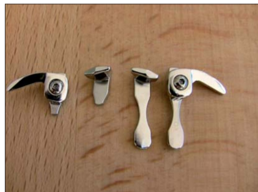
Abb. 7: Eventuell sind Vorschubstege und schiefe Ebene samt Trägerplatte individuell anzupassen.
