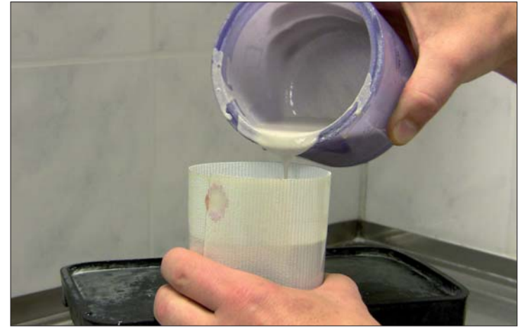
Abb. 17: Einbetten und Gießen.
