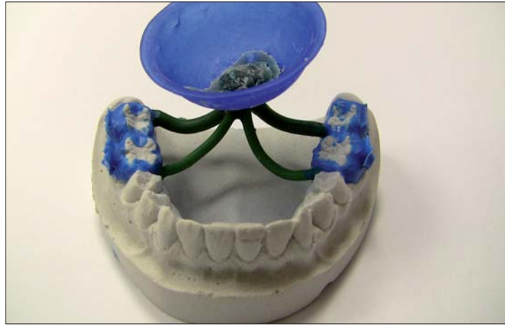
Abb. 16: Anbringen der Gusskanäle.
