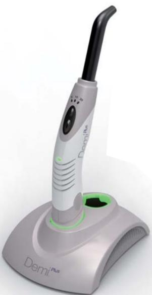
fach von 1.100 mW/cm<sup>2</sup> auf 1.330 mW/cm<sup>2</sup> gesteigert. Die Wellenlänge beträgt 450 bis 470 nm. PLS liefert ein kühles Licht mit durchgehend hoher Leistung, für eine echte 5-Sekunden-Polymerisation ohne Überhitzungsgefahr. Ein flüsterleiser Lüfter und ein einzig-
