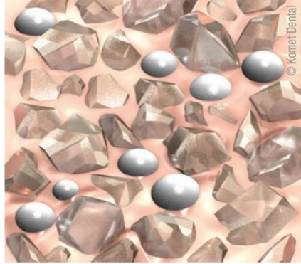
Die neuartige Diamantierung mit Keramikperlen zwischen den Diamantkörnern sorgt für überlegene Schärfe, die lange anhält. Anwender bestätigen, dass DIAO eine herausragende Kontrolle bei der Präparation gewährleistet und das druckarme Arbeiten die Behandlung nicht nur zeiteffizienter macht, sondern auch weniger ermüdend.
