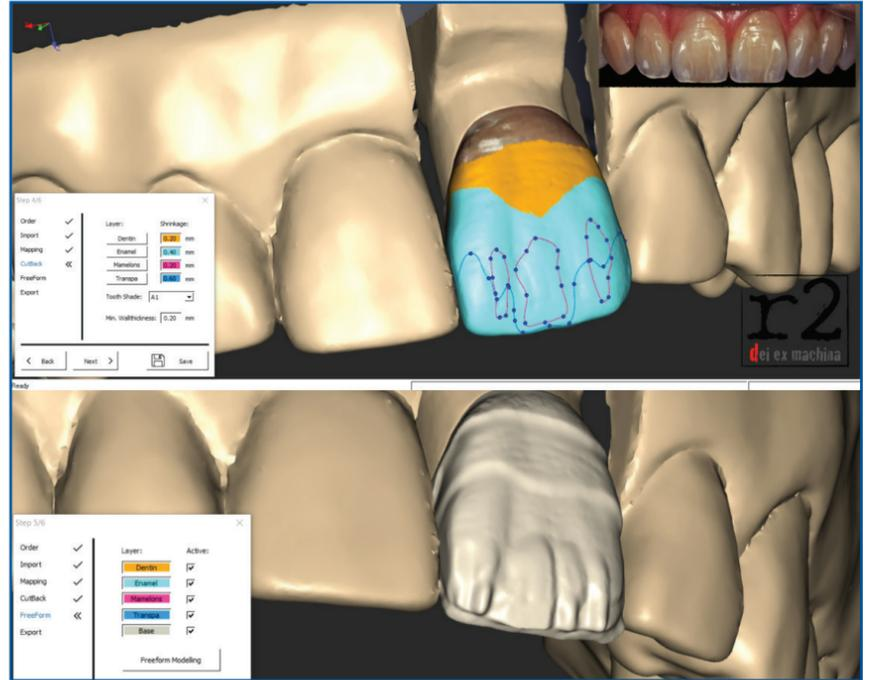
**Abb. 1:** Einladen der Gerüstdaten in die Stand-alone-Software cadBack (r2 dei ex machina). **Abb. 2:** Color-Mapping von Digitalfoto auf Konstruktionsdatensatz. **Abb. 3:** Präzises Festlegen farbrelevanter Bereiche. **Abb. 4:** Definierte Zuordnung der Reduktionsbereiche. **Abb. 5:** Die für das Micro-Layering optimierte Gerüstform. **Abb. 6:** Anzeigen der vollanatomischen Außenkontur zur möglichen Feinkorrektur.
