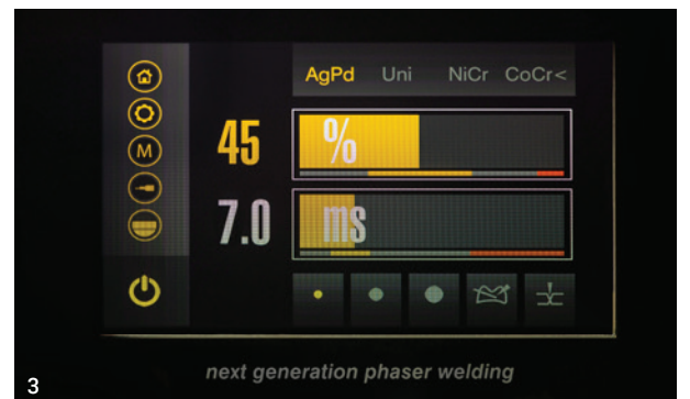
Abb. 2: „Das Auge isst mit“. Wertig und edel designt, ist der phaser mx3 ein echter Hingucker im Dentallabor. Abb. 3: Durch individuell programmierte Schweißkurven für jeden Legierungstyp können auch „schwierige“ Silber-Palladium-Legierungen problemlos geschweißt werden. (Bilder: © primotec Joachim Mosch e.K.)
